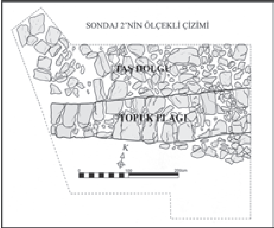
Çizim 4: Sondaj 2'de ortaya çıkan memba şevinin topuk plağı ve arkasındaki eğimli taş dolgu
